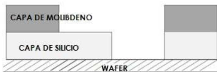
Figura 5.- Representación de recubrimiento de wafer para conocer las alturas.
