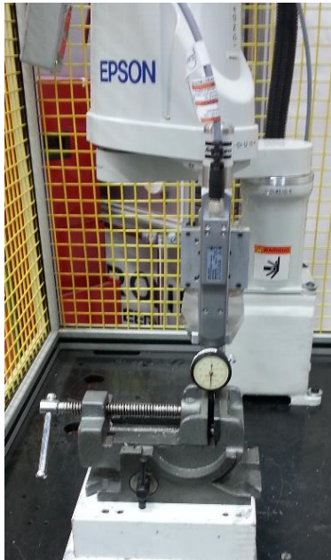
Figura 5. Galga de reloj para evaluación posición robot Scara
