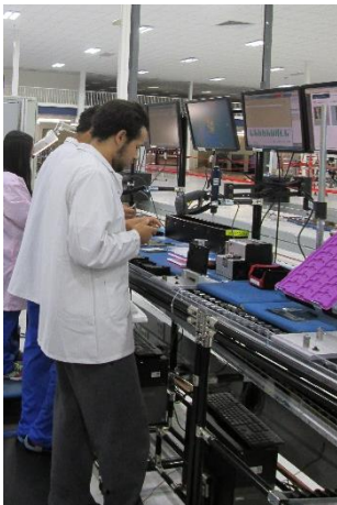
Figura 1. Celda de atornillado en proceso de manufactura
