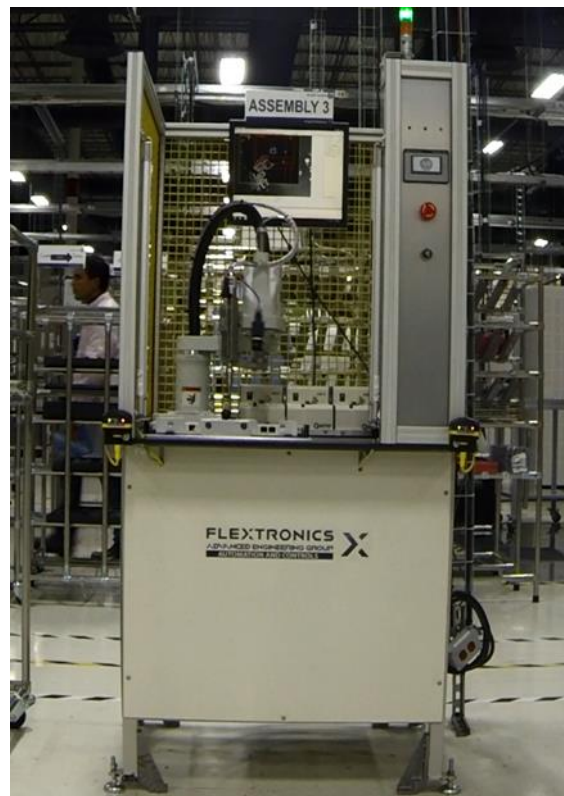
Figura 8. Celda Automática de Atornillado
