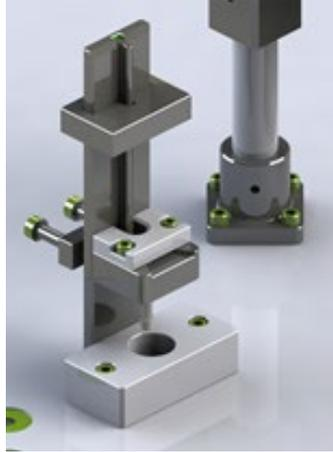
Figura 63. Diseño CAD final dispensador de anillos track
