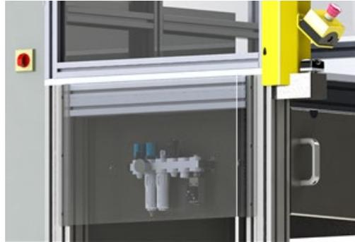
Figura 32. Diseño CAD final posición de unidad mantenimiento
