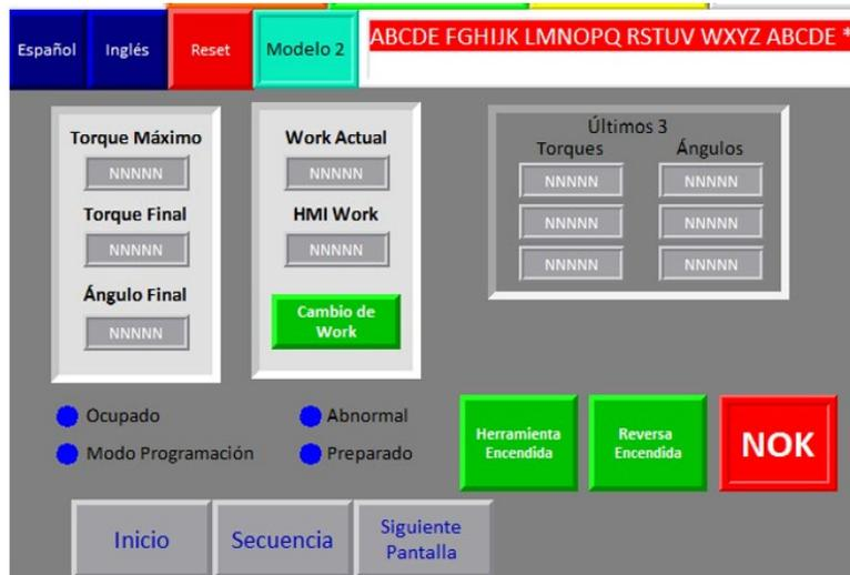
Figura 38. HMI pantalla “Monitoreo de Torque”
