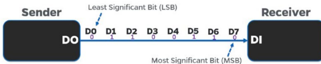
Figura 2. Diagrama Comunicación Serial (Gupta, 2019)
