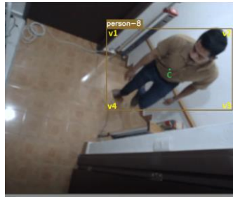
Figura 2. Detección de persona con nuestra herramienta de visión artificial. En color amarillo se identifican los cuatro vértices de la caja delimitadora (v1,v2,v3,v4), en color verde se identifica el centroide (C), o centro de la caja delimitadora,
