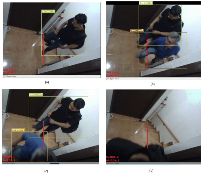
Figura 5. Secuencia de ascenso (subida) de escaleras. (a) La línea de cruce (línea roja) se coloca a la par de las barras con sensores infrarrojos. En la parte inferior izquierda de la pantalla se muestran los conteos de subidas (ascensos, cuando se cruzan las barras desde la escalera hacia el pasillo) y bajadas (descensos, cuando se cruzan las barras desde el pasillo hacia la escalera). Inicialmente el conteo comienza con dos bajadas debido a que esta prueba arranca al término de la anterior (prueba de descenso). Una persona aparece en escena (“person-6”) en dirección ascendente; esta aún no es contabilizada en este punto, ya que no se ha realizado el cruce de la línea de conteo. (b) Una segunda persona (“person-8”) aparece en escena. En este caso la persona marcada con el ID “person-6”, realiza intencionalmente una obstrucción de una de las barras, permaneciendo estática en esta posición durante un momento, con el fin de evitar que la persona marcada con el ID “person-8” sea contabilizada al cruzar las barras; esto para simular un caso real de obstrucción de barras a bordo de un autobús del transporte público. (c) La persona “person-8” completa el ascenso. Note como el contador de subidas de la parte inferior izquierda, ha contabilizado la subida. La persona “person-6” continúa obstruyendo una de las barras sin haber cruzado la línea todavía. (d) La persona “person-6” cruza la línea de conteo y sale de escena. Note como los contadores de la parte inferior izquierda de la pantalla, indican los dos ascensos realizados por “person-6” y “person-8”.
