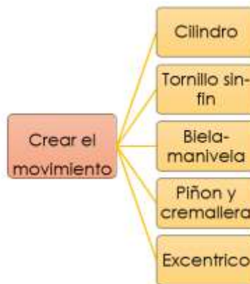
Figura 25.- Soluciones para crear el movimiento de las mordazas, Fuente: Propia
