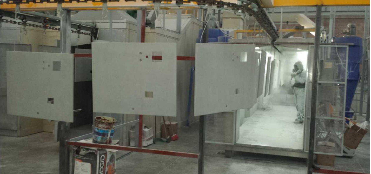
Figura 29. Aplicación de pintura en la línea nueva.
