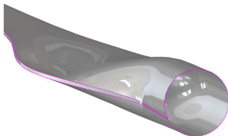
Figura 23. Representación del gap en el borde de salida.
