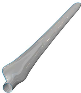
Figura 22. CAD de la superficie aerodinámica del aspa de 30 kW.
