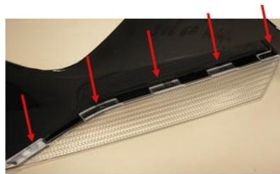
Figura 3. Unión Laser por puntos
