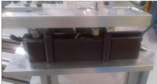
*Figura 8. Dispositivo Mecánico que transporta a posición los cilindros neumáticos de sujeción.*
