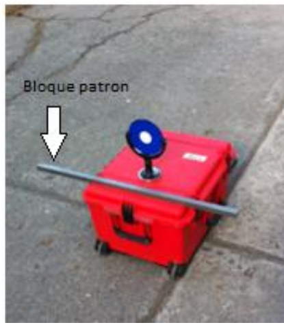
Figura 4.- Bloque patrón y target con el que se realizaron las mediciones.
