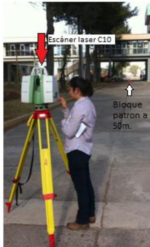
Figura 5.- Escaneando el bloque patrón a una distancia de 50 metros.
