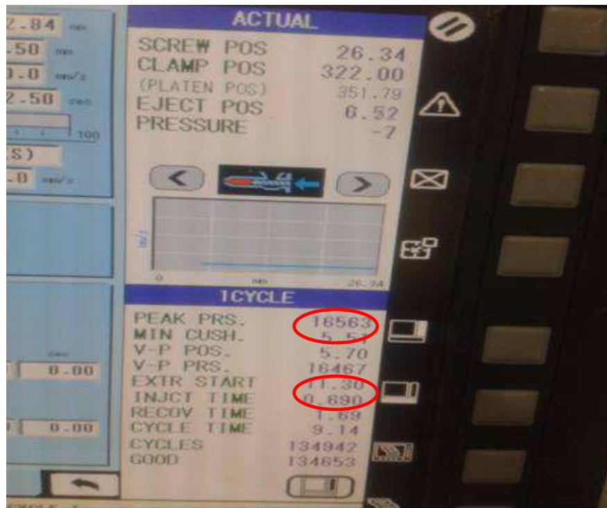
Fig. 3 Parámetros en pantalla de Máquina de moldeo.
