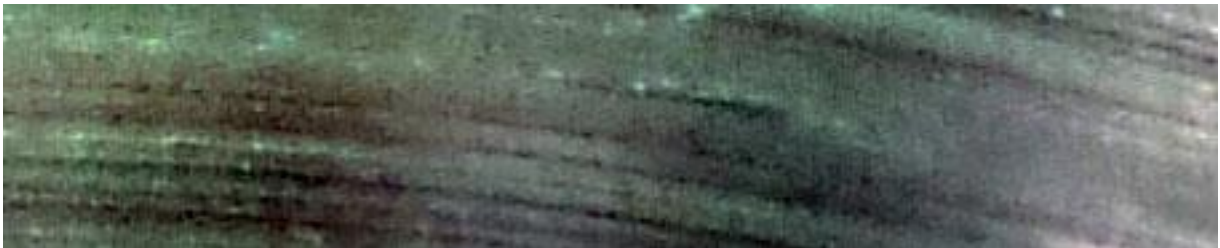
Figura 4.18 Acabado final Modulación triangular velocidad 990rpm
