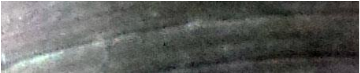
Figura 4.15 Acabado final Modulación triangular velocidad 550rpm
