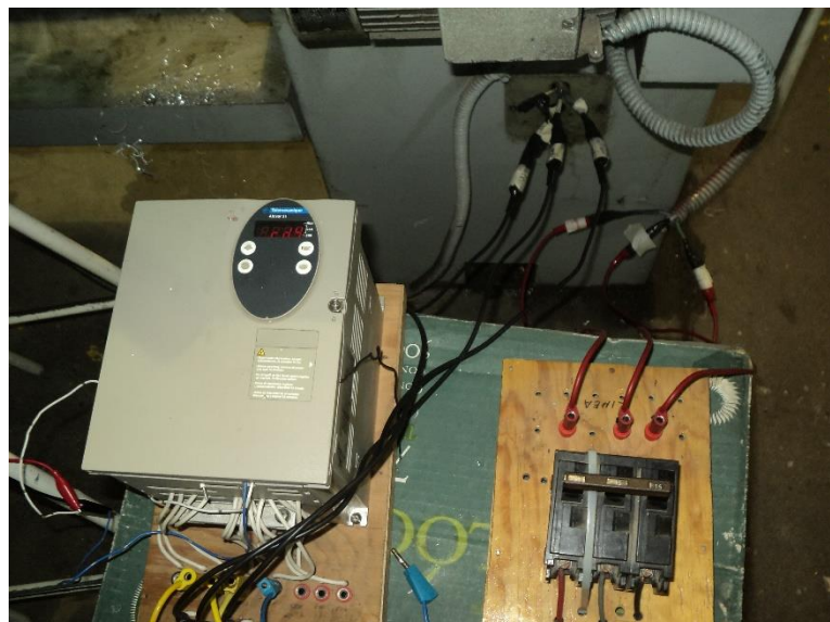
Figura 3.10: Variador ALTIVAR 31 conectado al motor de la fresadora TRAK-DX2
