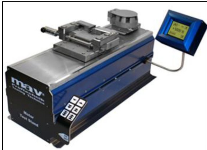
Figura 17. Equipo para prueba de desprendimiento
