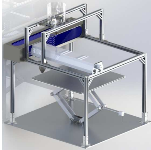
Figura 4. Modelo Geométrico de la impresora 3D
