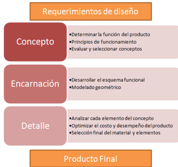
Figura 3. Etapas de diseño del prototipo de impresora 3D
