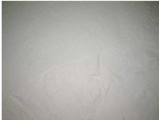
Figura 7. Muestra de polvo ABS reciclado
