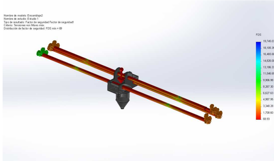
Figura 11. Factor de seguridad para el eje X
