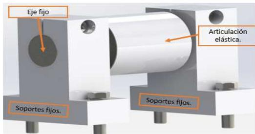
Figura 4. Soporte con buje antivibración.
