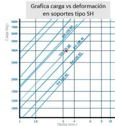
Figura 6. Carga vs deformación de soporte tipo SH [1].
