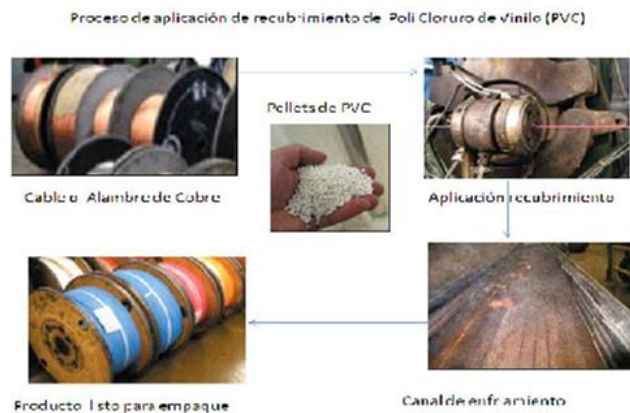
Fig. No 1. Proceso de aplicación de recubrimiento de PVC a cable o alambre de cobre
