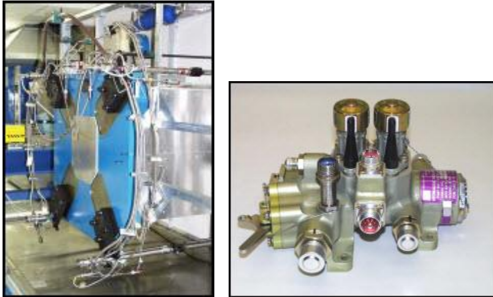
Figura 1. Celda de prueba del sistema de reversa en Woodward (izq.) Válvula de control hidráulico GE/Woodward (der.) [1]
