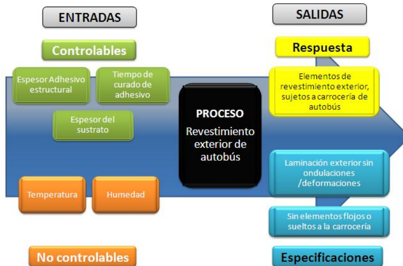
Figura 2. Esquema de variables identificadas en el proceso de revestimiento exterior
