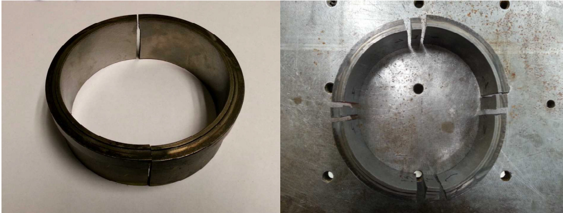
Fig. 4 Sección de cilindro combustión interna. Fig. 5 Piezas recortadas a 90° en cilindro.
