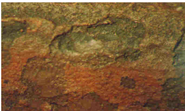
Figura 3. Fotografía de un Alabe que muestra picaduras por corrosión [i].
