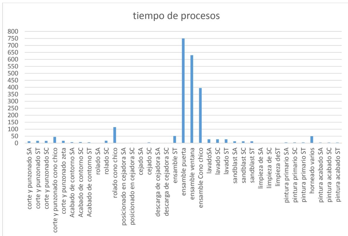
**Figura 5** resumen de consumo de tiempos de fabricación por unidad procesada.
