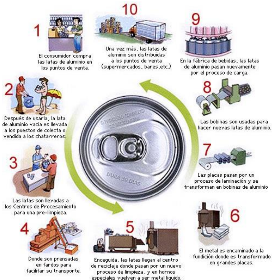
Fig. 4 Ejemplo de reciclado de una lata de aluminio.
