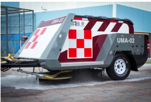
Figura 21. Remolque de pavimentos, proceso de lavado y remoción de lodos.
