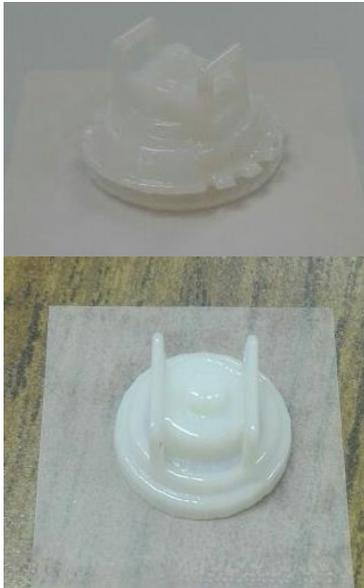
**Figura 15.** Boquillas impresas con tecnología Polyjet™.
