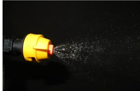
**Figura 16.** Chorro producido por la boquilla comercial.
