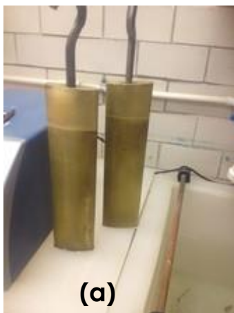
Figura 15. Imágenes de los electrodos: a) ánodos y b) cátodo después de realizar el proceso de electrodeposición, aplicando agitación con propela a 350 rpm.
