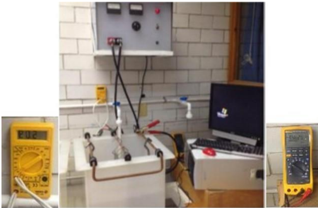
Figura 4 Imagen de la celda electrolítica conectada a la fuente de poder y los multímetros para censa el potencial y la corriente.
