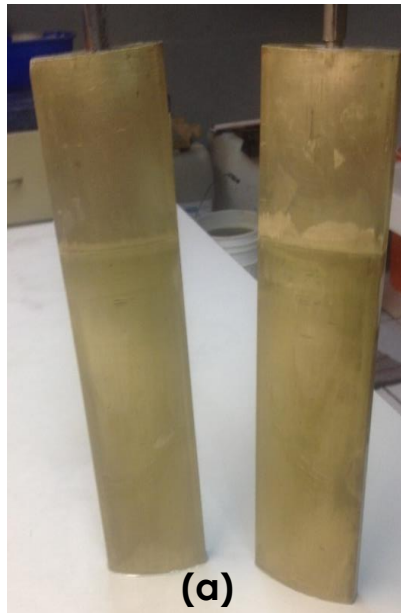
Figura 23. Imágenes de los electrodos: a) ánodos y b) cátodo después de realizar el proceso de electrodeposición, imponiendo el valor del potencial a -0.42 V.
