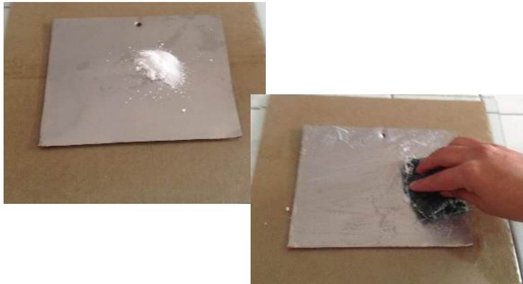
Figura 5 Preparación de la pieza a recubrir: lavado inicial de la pieza con jabón a base de hidróxidos.
