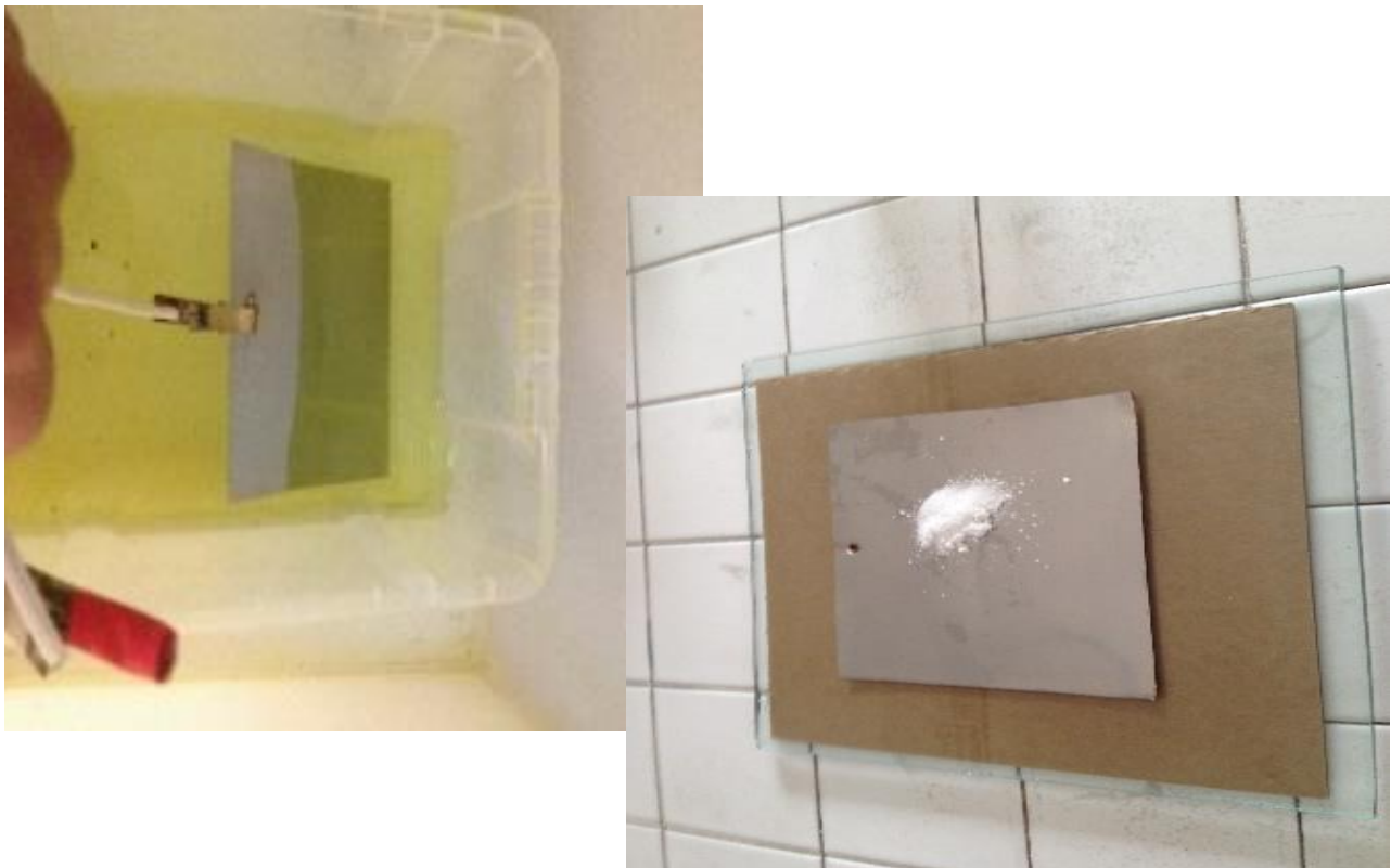
Figura 8 decapado químico con una solución de ácido clorhídrico al 10%, por alrededor de 30 segundos.
