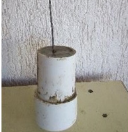
a) Varillado de la mezcla
