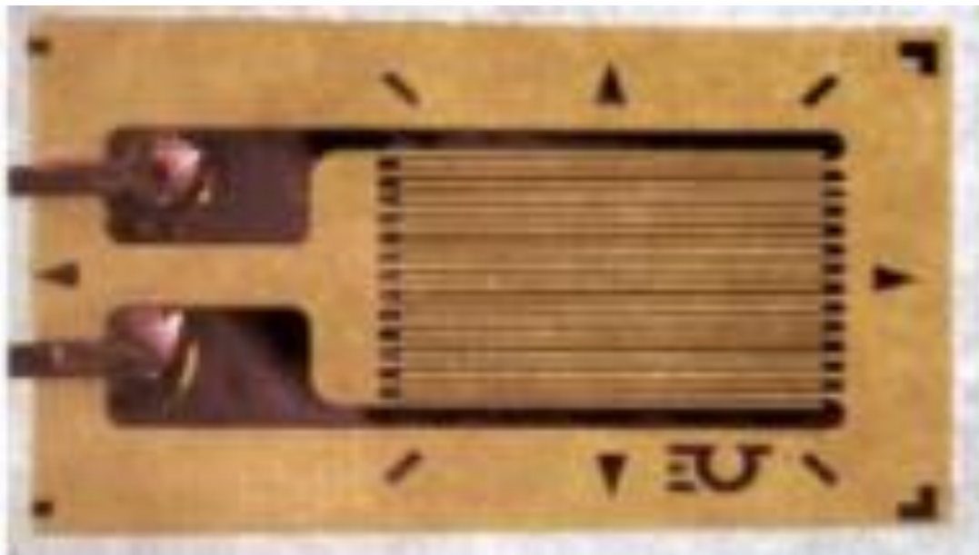
Fig. 14. Galga extensométrica. Su resistencia eléctrica cambia cuando sufre un estiramiento o una compresión 7 .
