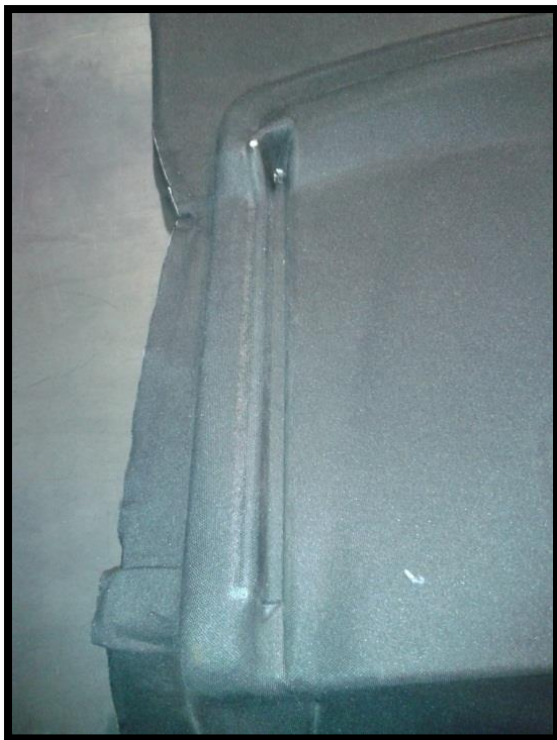
Fig. 2.7 Panel termoformado con sustrato y tela. La figura de la izquierda muestra la porción de un panel posterior al termoformado y antes de pasar a proceso de terminación. La figura de la derecha muestra la porción de un panel montado en vehículo. [5]
