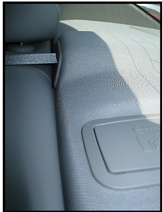
Fig. 2.7 Panel termoformado con sustrato y tela. La figura de la izquierda muestra la porción de un panel posterior al termoformado y antes de pasar a proceso de terminación. La figura de la derecha muestra la porción de un panel montado en vehículo. [5]
