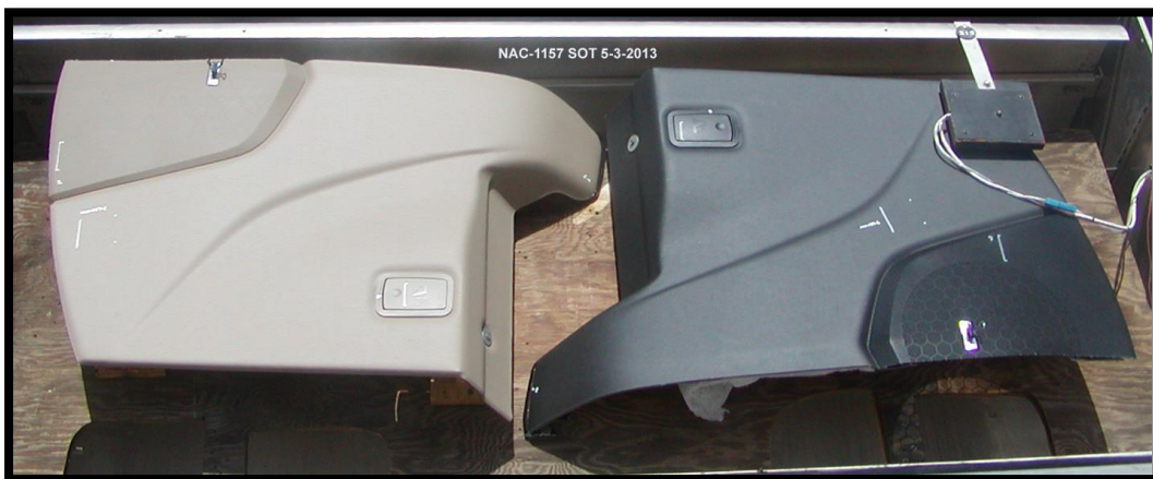
Fig. 2.9 Partes físicas de una cubierta instrumentada durante una prueba, con el sustrato de PP+fibra de vidrio, Poliuretano y PVC. [6]
