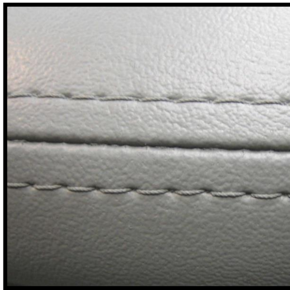
Fig.3.4 en la figura a) tenemos una pieza moldeada con "Elastoskin®" que muestra detalle de costura hechas con el mismo moldeado. Por otro lado en la fig. b) podemos ver costuras reales. La percepción de ambas ejecuciones es idéntica para el cliente. [15]
