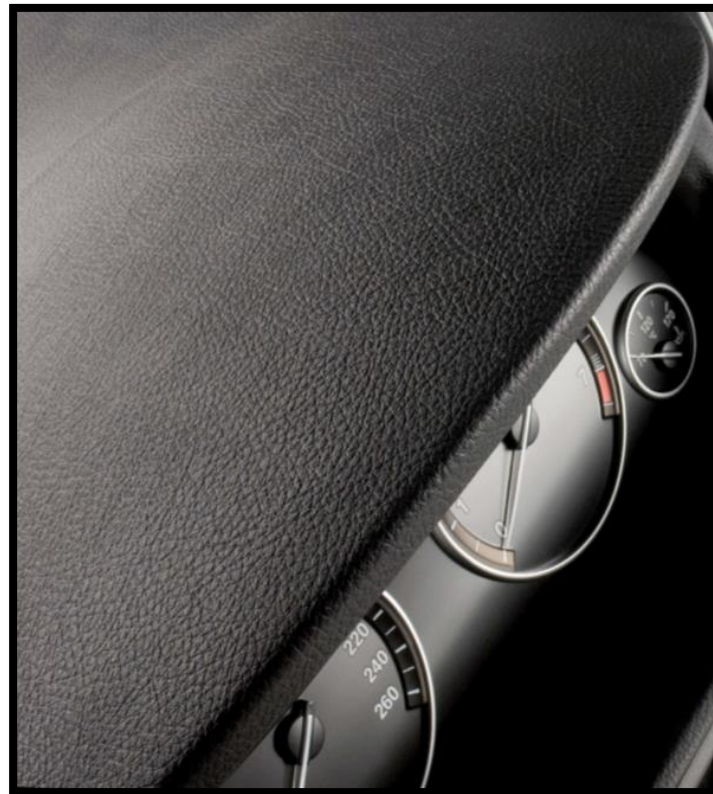
Fig. 3.1 Se observa el uso actual que tiene el “Elastoskin®” en un panel de instrumentos. De igual forma se aprecia el nivel de detalle del grano en su acabado. [14]
