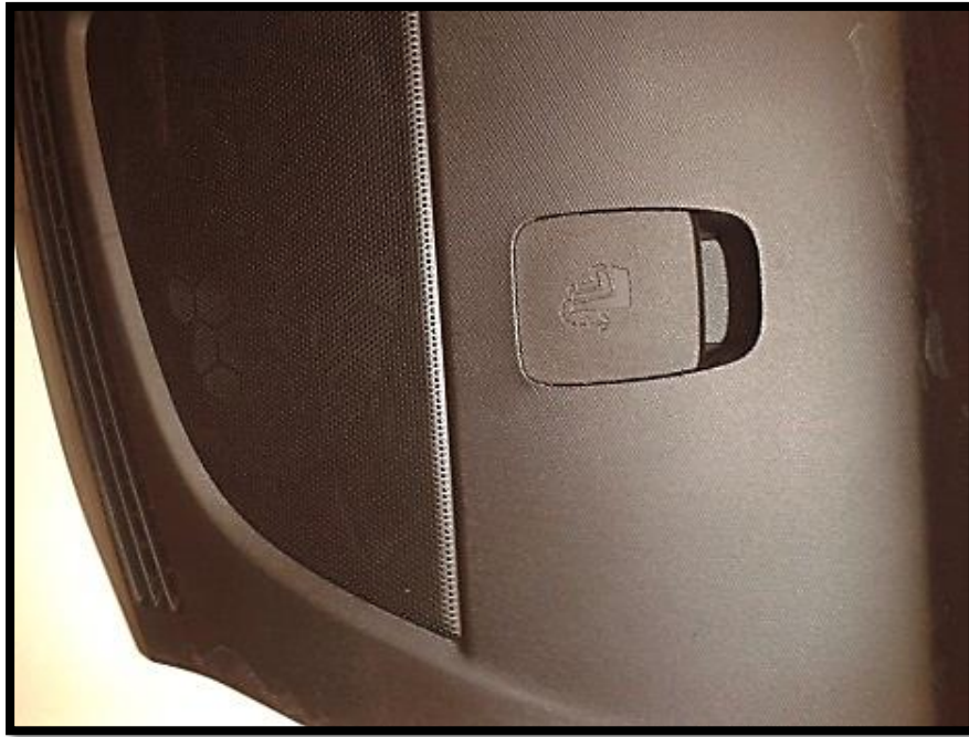
Fig. 2.6 Panel moldeado en plástico (TPO) con grano de apariencia. Se puede observar que tiene moldeada la cubierta para la bocina y la rejilla para el flujo de aire en parte trasera. La cubierta para anclaje de la silla de niños es moldeada por separado y se ensambla al panel. [3]
