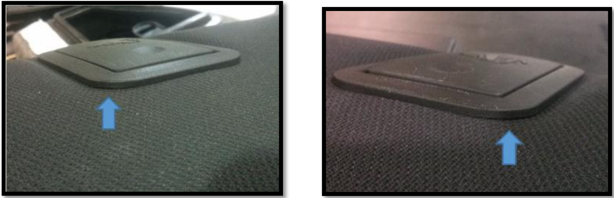
Fig. 2.18 Muestra una abertura entre la cubierta para anclaje de la silla de niños y la tela de apariencia.
