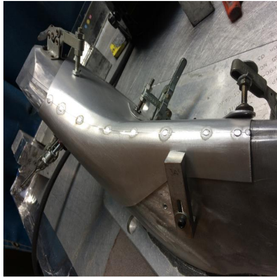
Figura 4.10 Punteado del ensamble de ingeniería CC690-15356 modelo -1 y -2 (Leading Edge Skin Transition)
