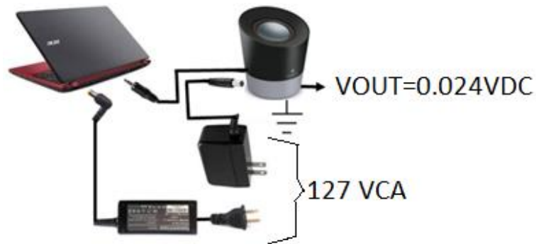
Figura 51. Esquema de conexión de hardware para obtener un bit útil a través de la señal de audio
