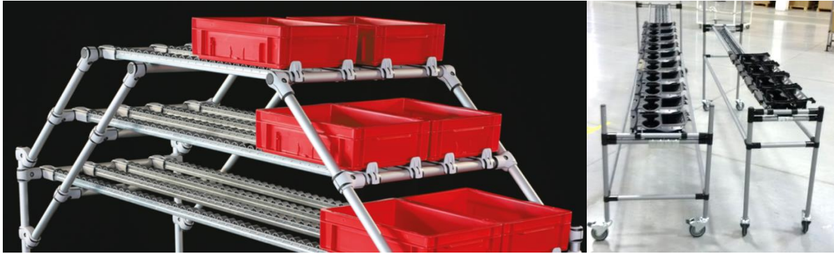
Figura 32. A la izquierda bandas transportadoras de rodillos para transportación de contenedores. A la derecha bandas transportadoras de rodillos, nótese la ventaja de poderse aplicar directamente contra autopartes, en las zonas planas de estas
