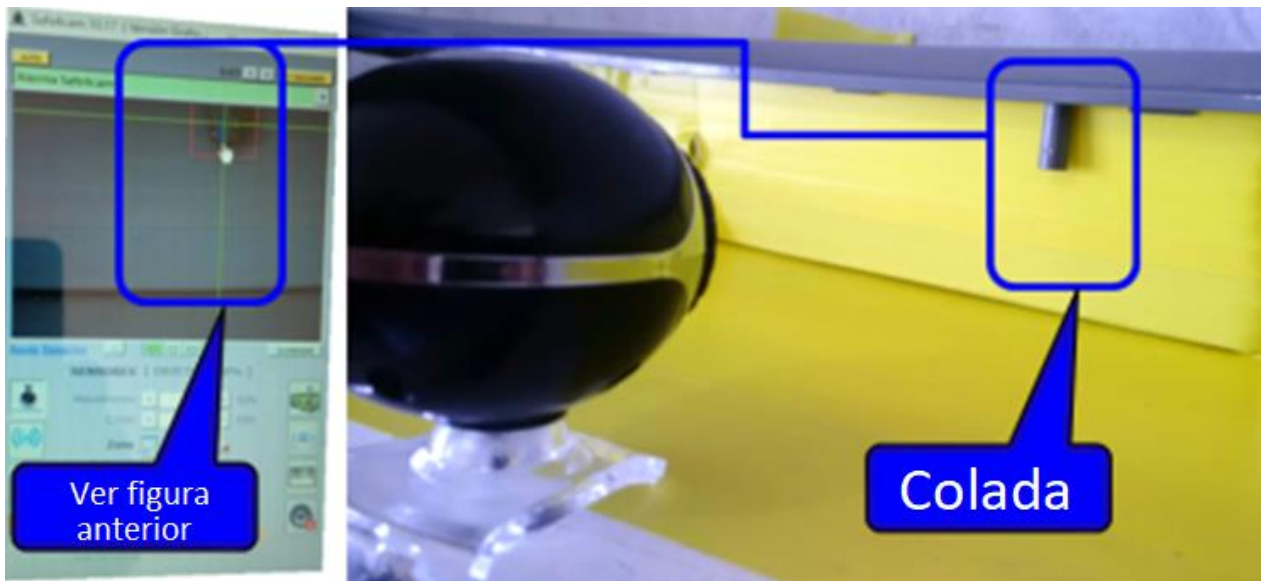
Figura 49. Detección de colada a través de la técnica de seguimiento de color en Safe4cam (izquierda) vs escena real (derecha)
