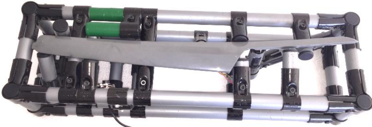
Figura 63. Ejemplo de un nido de posición única para el caso A con material TRILOGIQ
