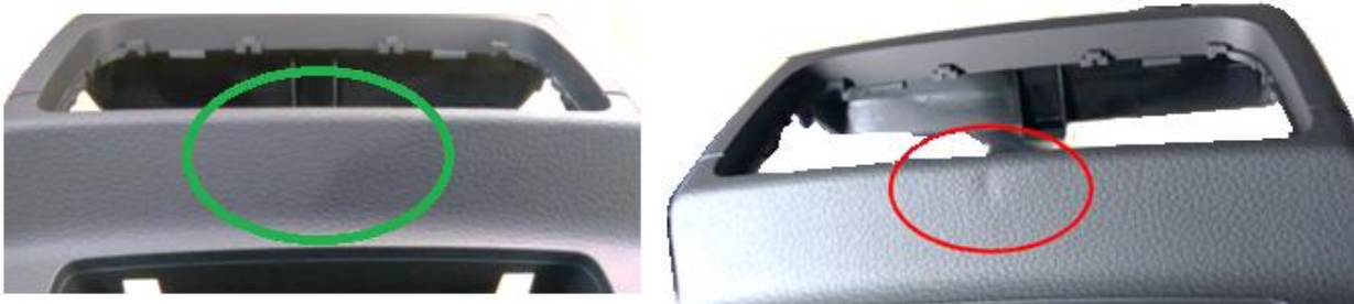
Figura 4. Pieza correcta (izquierda) y pieza con rechupe (derecha)
