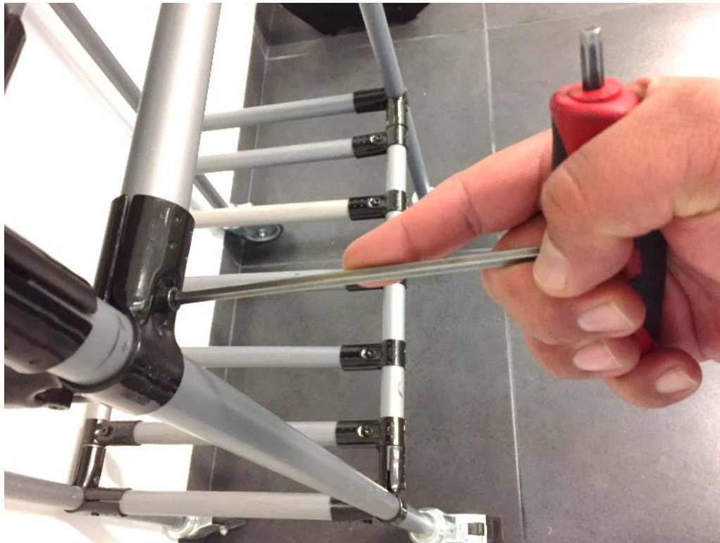
Figura 27. El ensamble no requiere soldadura, ni pintura, sólo una llave hexagonal "T" de 5 mm
