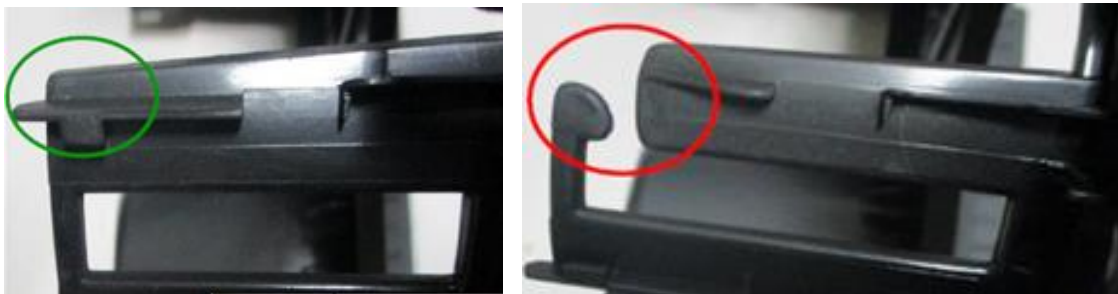
Figura 2. Pieza correcta (izquierda) y pieza con falta de llenado (derecha)
