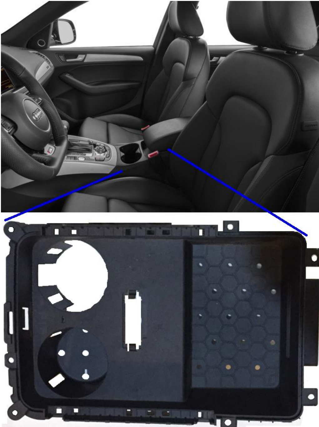
Figura 44. La autoparte Trim Cover y su ubicación en el interior del modelo Q5 de Audi. Cada pieza de Trim Cover debe estar libre de defectos de pintura (grumos, escurrimientos, porciones sin pintar, etc.), libre de defectos de moldeo (rechupes, deformaciones, tiros cortos, etc.), y tener la capacidad de ensamble.
