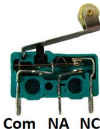
Figura 17. El interruptor de proximidad, en este caso normalmente abierto
