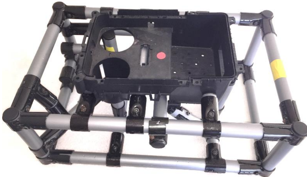
Figura 67. Ejemplo de un nido de posición única para el caso B con material TRILOGIQ. Este nido corresponde al que detecta la falta de llenado (o tiros cortos) en la pieza Trim Cover. Restringe el movimiento de la pieza a una única posición en la cual la pieza es detectada mediante un sensor infrarrojo e18 como se muestra en la figura 68.
