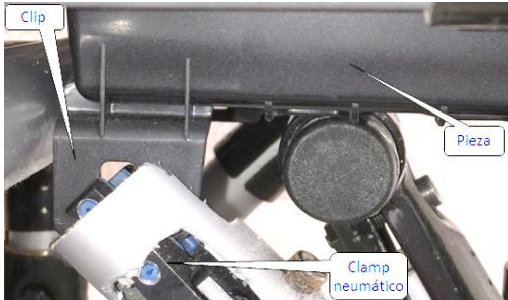
Figura 69. Sujeción de la pieza caso B con clamp neumático
