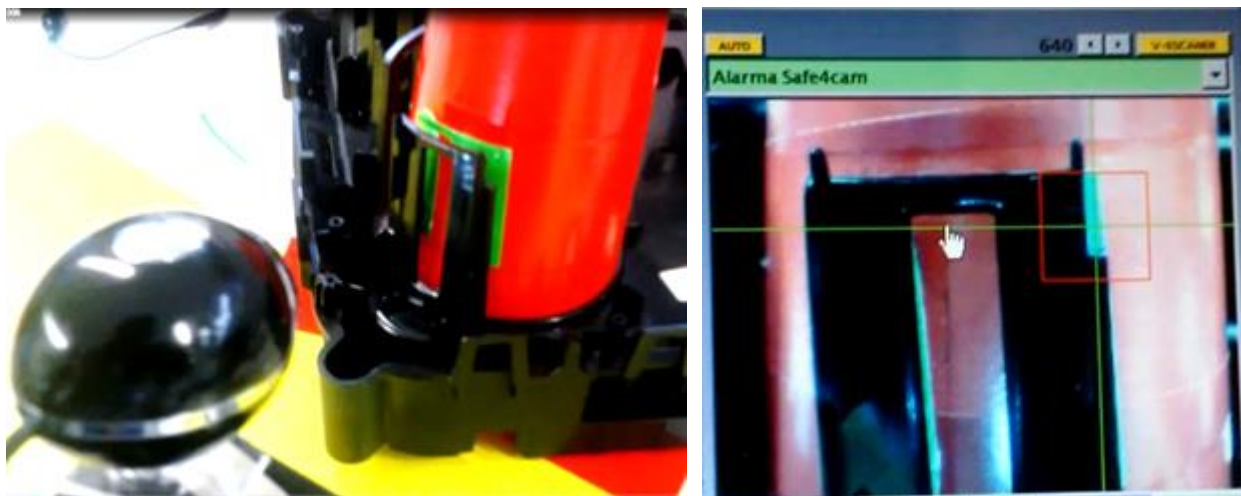
Figura 56. Del lado izquierdo la detección de falta de integridad con la escena controlada, del lado derecho la interfaz de Safe4cam detectando el fondo verde que no debe ser visto para piezas correctas
