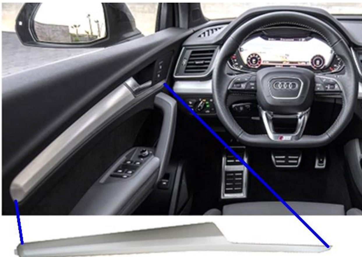
Figura 40. La autoparte Front Door y su ubicación en cada una de las 4 puertas en el interior del modelo Q5 de Audi, hay un Front Door para puerta izquierda y otro Front Door para la puerta derecha, semejantes y reflejados entre si
