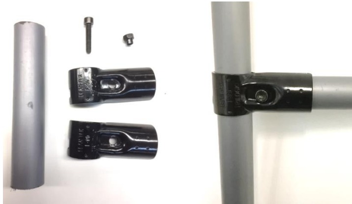
Figura 28. A la izquierda se muestra una fracción del tubo T1-400, 2 conectores F-90, tuerca y tornillo S1. A la derecha se muestran los componentes de la izquierda ensamblados en otro tubo T1-400
