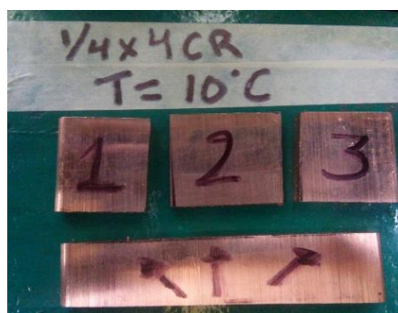
Figura 2. Ejemplo de muestras para pruebas metalográficas.
