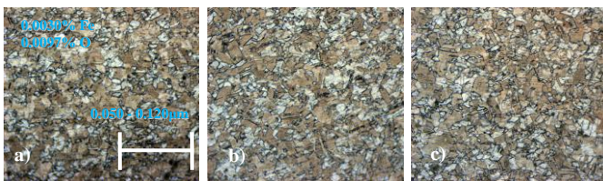
Figura 11. Microestructura a 10°C temperatura de enfriamiento
