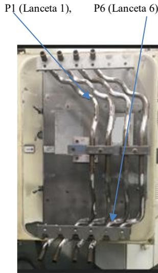
Figura 10. Ubicación puntos de medición esfuerzos residuales compresivos en barras estabilizadoras
