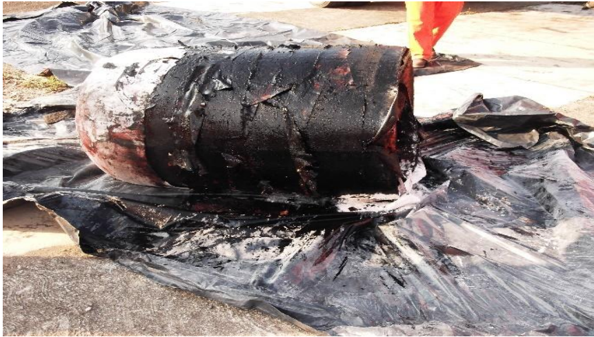
Figura. 2.3 Polly Pig después de una corrida de limpieza (Autor).
