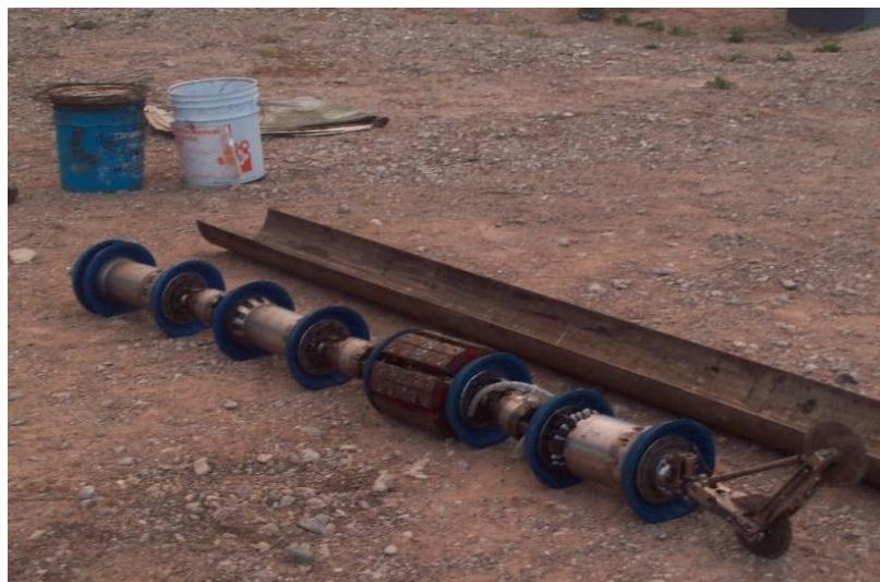
Figura. 2.8 Equipo instrumentado ultrasónico (T. D. Willians)
