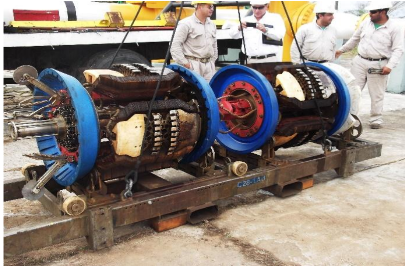
Figura. 2.7 Equipo instrumentado de Pérdida de Flujo Magnético (H. Rosen)
