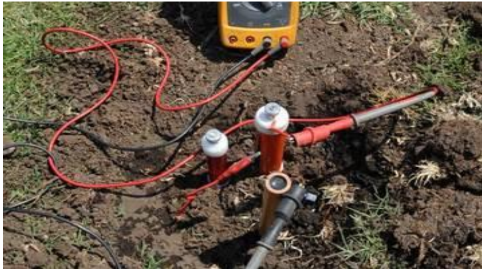
Figura. 2.11 Tomando de Potenciales para evaluación de corrosión externa (Pemex)
