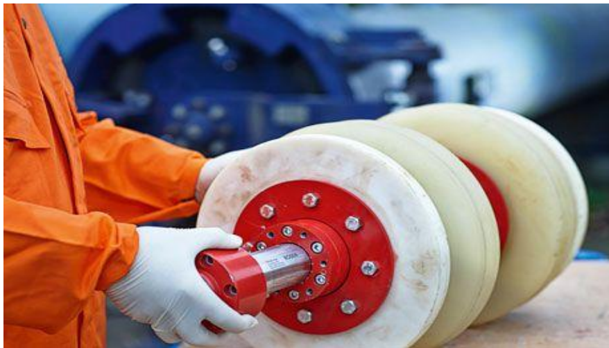
Figura. 2.4 Equipo de limpieza con discos sellantes (H. Rosen)
