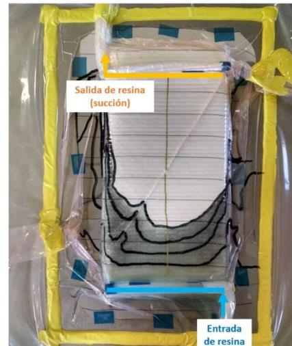
**Figura 7.** Registro del frente de resina para el experimento 2 a los 10 minutos de iniciar la infusión de resina. Fuente: elaboración propia.
