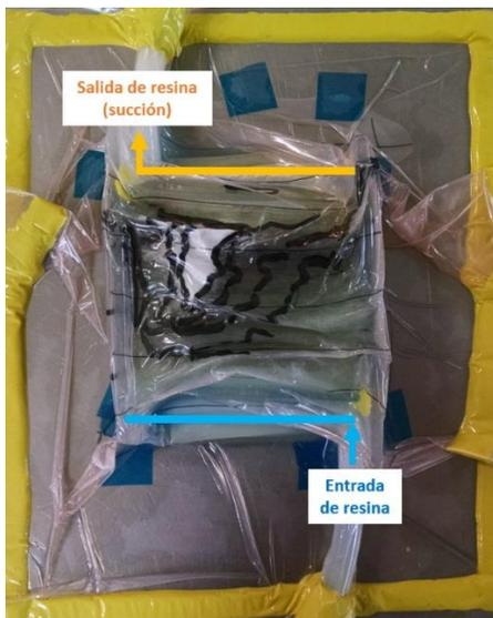
**Figura 9.** Registro del frente de resina para el experimento 3 a los 10 minutos de iniciar la infusión de resina. Fuente: elaboración propia.
