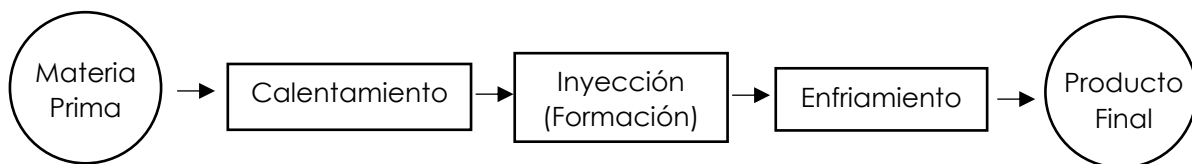
Figura 1. Etapas del Proceso de Inyección
