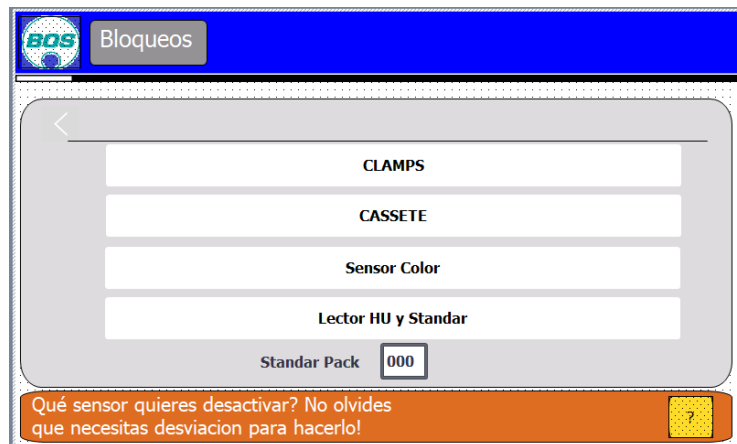
Figura 58.-Pantalla HMI bloqueo de sensores.
