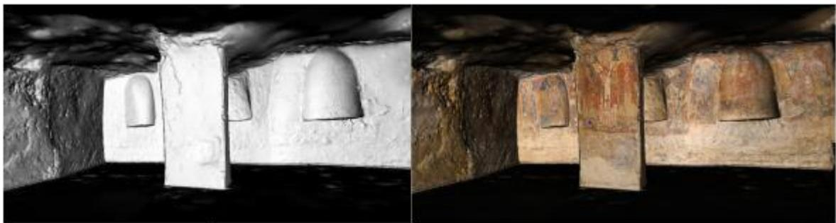
Figura 25. A la izquierda el modelo 3D obtenido por escaneo láser. A la derecha el modelo 3D con la textura obtenida por fotogrametría<sup>[27]</sup>.
