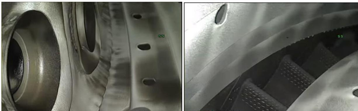
Figura 40. Imagen del interior de la cámara de combustión. La figura de la izquierda muestra la pared de inyectores y los orificios de presión. La figura de la derecha muestra la rejilla de ventilación entre las dos paredes laterales con orificios de presión<sup>[51]</sup>.
