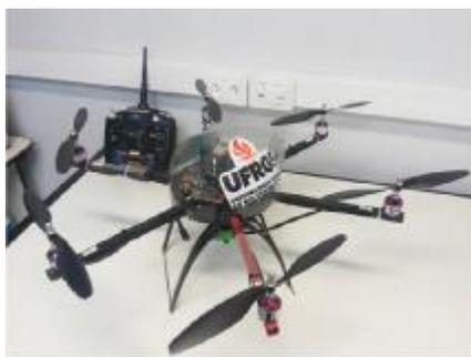
Figura 6. Vehículo autónomo sin piloto con cámara para inspección de estructuras<sup>[10]</sup>.
