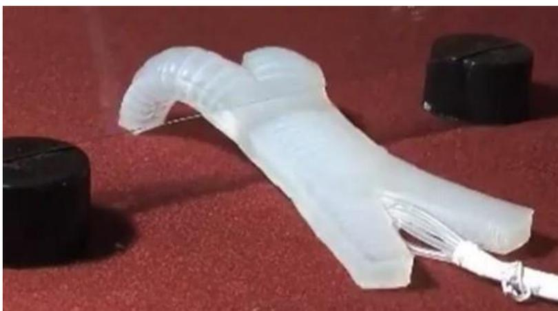
*Figura 1. Soft Robot creado por científicos de Harvard diseñado de material flexible que le permite deslizarse por áreas inaccesibles<sup>[21]</sup>.*
