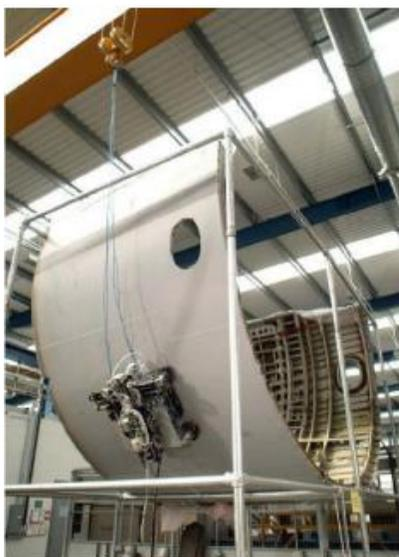
*Figura 15. Robot de desplazamiento por principio de succión utilizado para análisis y determinación de curvaturas en estructuras aeronáuticas [47].*
