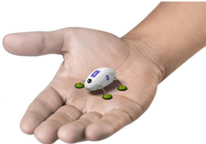
Figura 14. El robot 'cucaracha' de 10 mm de Rolls Royce tiene por objetivo simplificar actividades de inspección y reparación en componentes aeronáuticos<sup>[20]</sup>.
