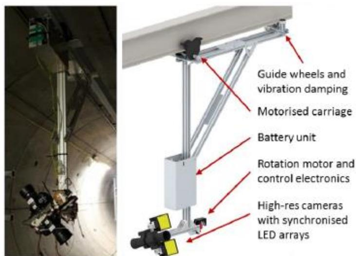
Figura 7. Sistema de bajo costo para inspección visual eficiente de túneles<sup>[45]</sup>.
