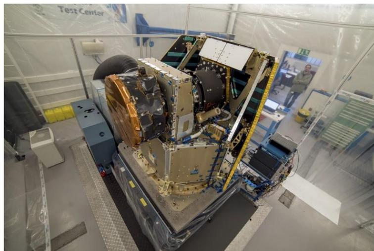
Figura 4. Posicionamiento del CHEOPS en una mesa de agitación para realizar pruebas de estructurales del satélite<sup>[41]</sup>.
