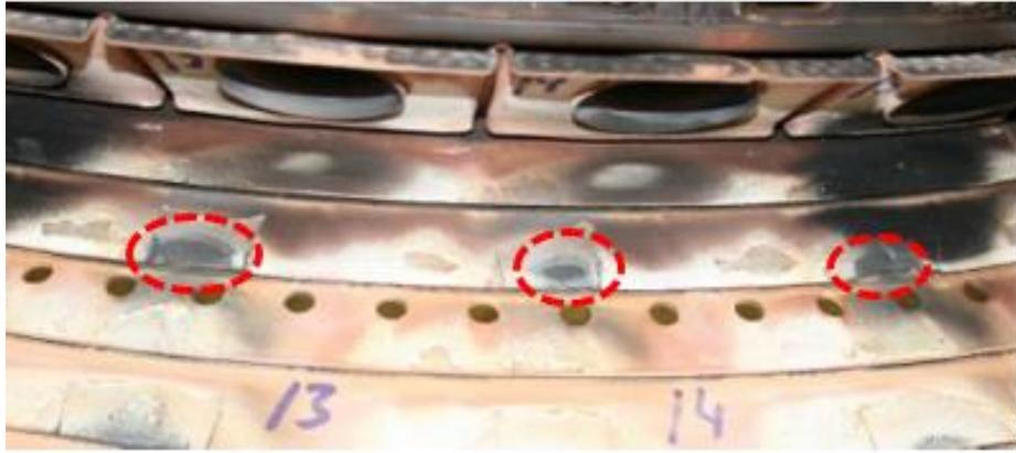
Figura 13. Grietas observadas dentro de una cámara de combustión<sup>[49]</sup>.
