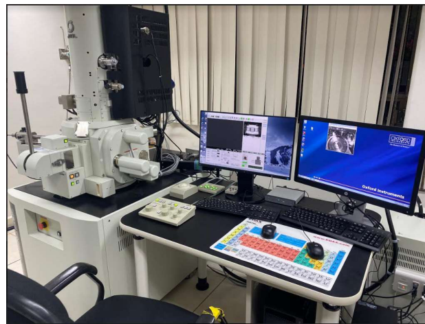
Figura 21. Microscopio electrónico de barrido de emisión de campo (FESEM).
