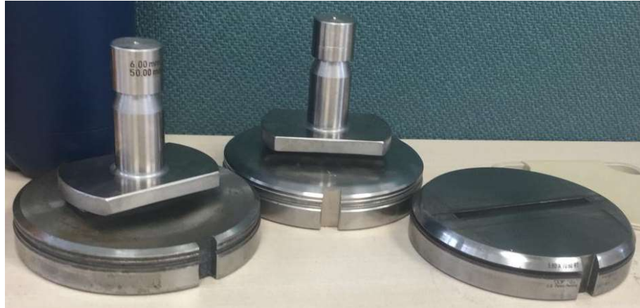
Figura 15. De izquierda a derecha: matriz nueva, recién afilada y por afilar, respectivamente.
