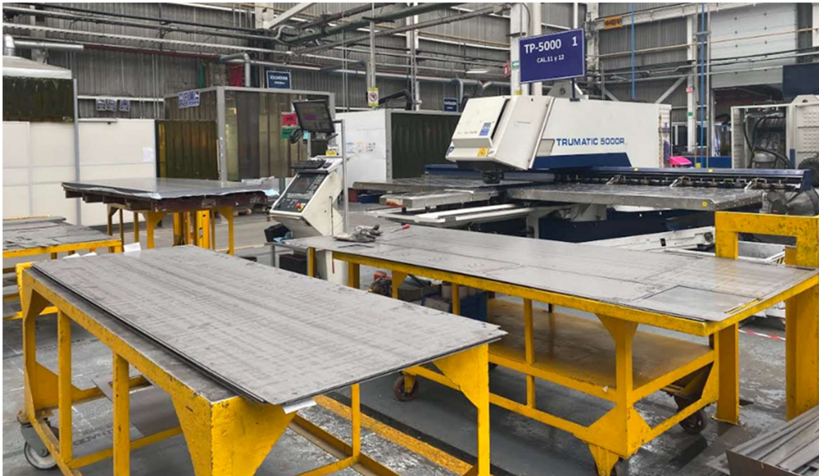
Figura 23. Máquina punzonadora "Trupunch 5000" para procesamiento de lámina calibre 11 y 12.
