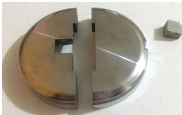
Figura 17. Representación del corte de la matriz y cubo de 150 mm, para la medición de dureza.
