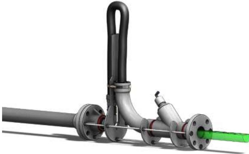
Figura 69 Diseño final, carrito simulador de flujo estratificado.
