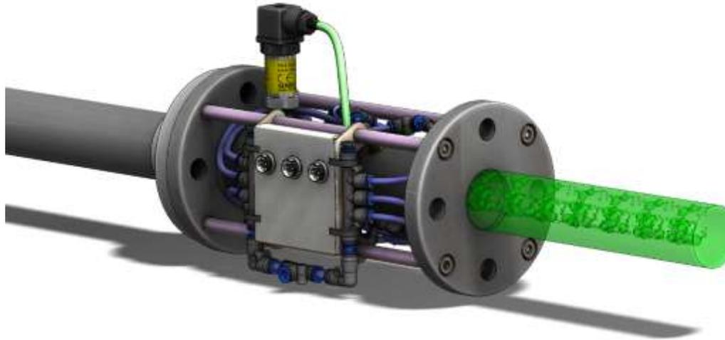
Figura 46 Diseño final, carrete simulador de flujo burbujas.
