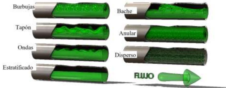
Figura 2 Regímenes de flujo horizontal multifásico.
