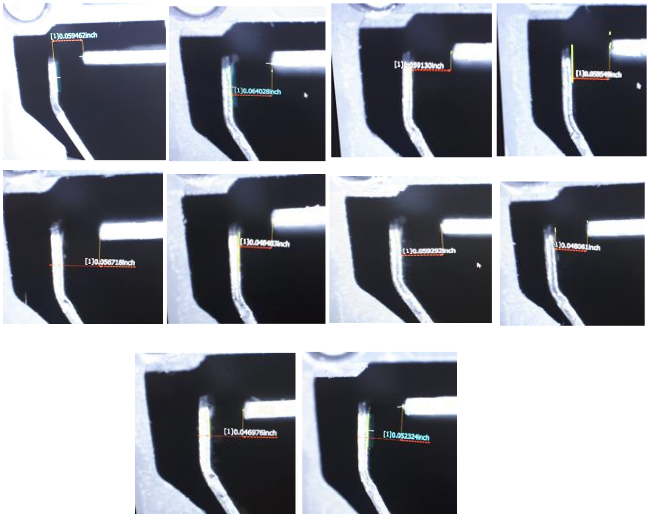
Figura 62. Medición de separación entre bimetal y connecting plate una vez colocados los tornillos de calibración.
