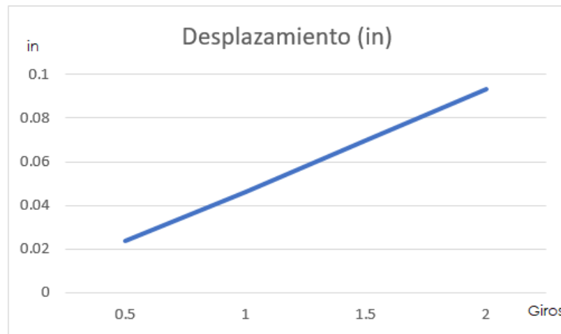
Figura 60. Desplazamiento del bimetal vs giros de tornillo de calibración.
