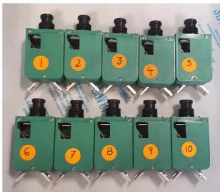
Figura 42. Disyuntores modificados e identificados.
