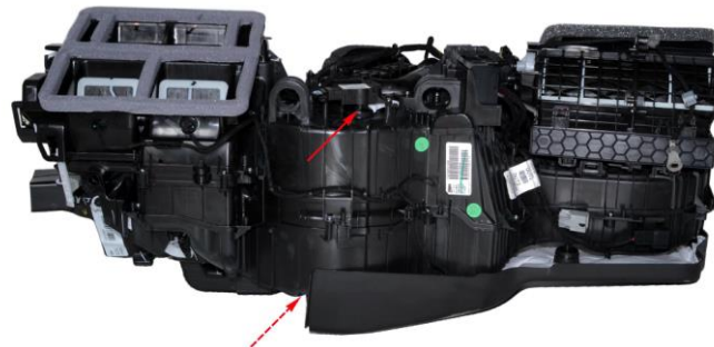
Figura 2. Módulo de aire acondicionado.
