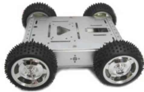
Figura 2 Chasis de 4 ruedas Fuente: Elaboración propia (2018)
