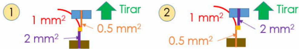
Figura 3. Ejemplo de empalme triple con cables de área transversal de 0.5, 1 y 2 mm 2
