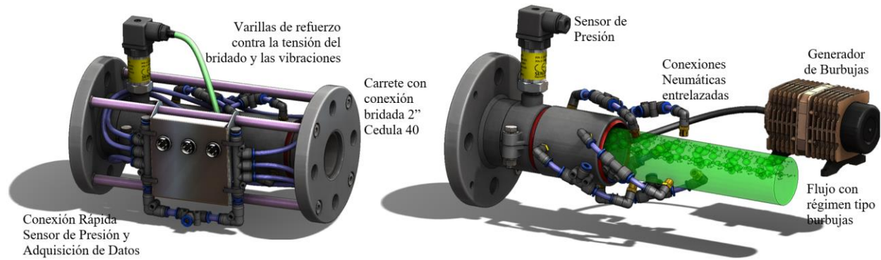
Figura 3. Diseño propuesto del carrete simulador de flujo de régimen burbujas.
