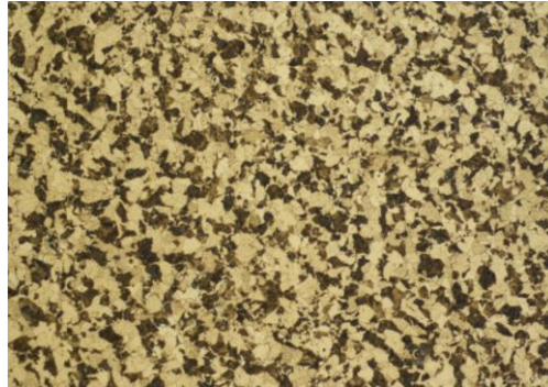
Figura 23. Resultado de análisis de microestructura de blank Acero 5120H con resolución a 400X. (Elaboración propia)
