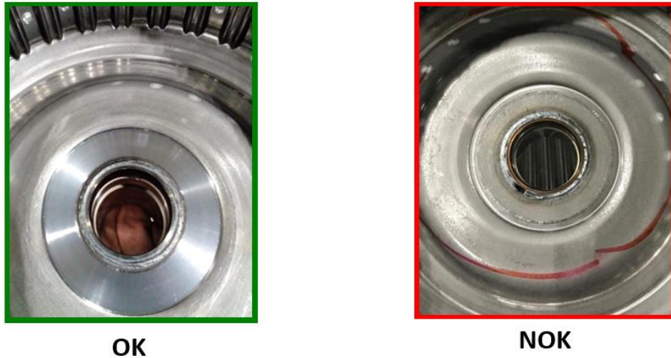
Figura 1. Unión de soldadura láser entre engrane y plato aceptable y no aceptable. (Elaboración propia)
