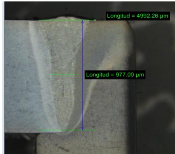
Figura 29. Resultado de penetración de soldadura con parámetros óptimos.
