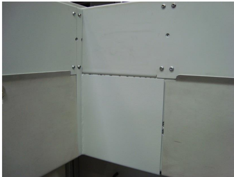
Figura 18. Uniones externas en estaciones de prueba eléctrica.
