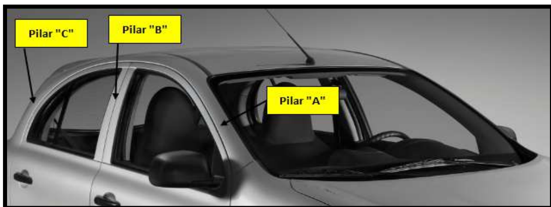
Figura 1.1 Pilares A, B y C en un vehículo hatchback Fuente: elaboración propia.
