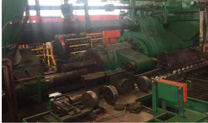
Figura 31. Prensa de extrusión de soleras de cobre
