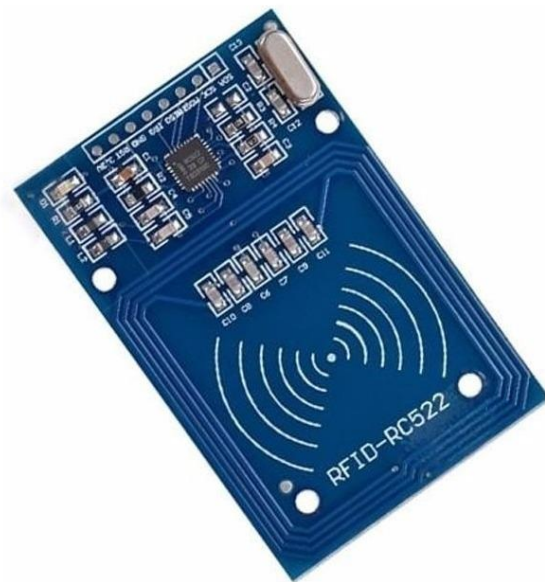
Figura 8: Aspecto físico del RFID-RC522 [75]
