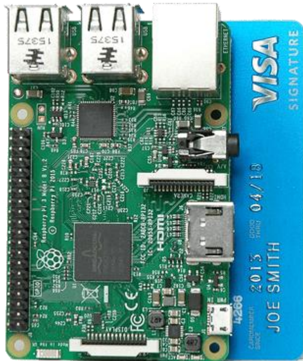
Figura 25: Raspberry Pi 3, comparación de tamaño [74]
