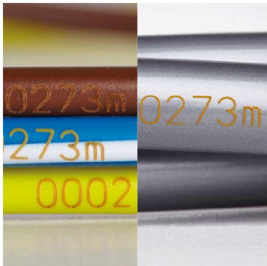
Figura 2. Ejemplo del marcaje por láser [10]
